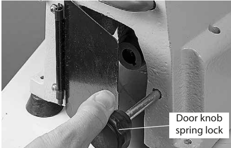
Motor pulley access door
